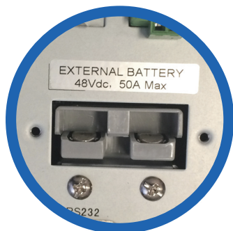
Entrada banco de baterías externas
